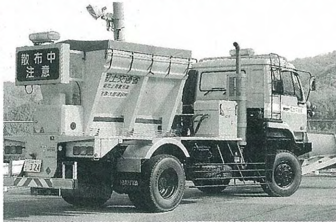
稲武の国道153号沿いにある国交省の雪寒基地を出発する雪氷対策車両。
